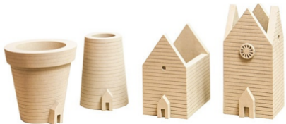
▲ Intreccio独立水槽，保罗·乌连（Paolo Ulian）为antonio lupi设计，由同心环形状的大理石堆叠、交错而成，采用数控机械优化切割，最大限度减少废料，一整块大理石可制作成四个水槽。
